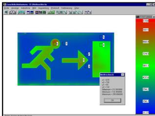
Die Leuchtdichteverteilung ist ein wesentliches Kriterium zur Kennzeichnung von Leuchten. Neben der Qualitätssicherung bei der Produktion zur Realisierung entsprechender Vorschriften wird sie auch marktwirksam in Katalogen verwendet.
