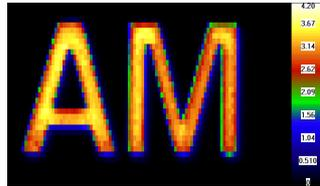
Die Farbpaletten lassen sich auf beliebig wählbare Leuchtdichtebereiche anpassen. Ungleichförmigkeiten sind dadurch besonders gut erkennbar.
