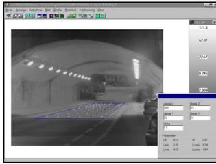
Die DIN5044 und DIN67524 schreiben die notwendigen Leuchtdichten für Straßen und Tunnel vor. Die rechentechnische Erfassung einer Vielzahl von Messpunkten ermöglicht die schnelle Vermessung unterschiedlicher Beleuchtungssituationen. Wesentliche Parameter sind:
