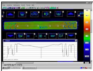
Leuchtdichteverteilungen, Kontraste auf Displays insgesamt aber auch für einzelne Symbole zu messen, ist für die Entwicklung, wie für die Fertigungsüberwachung im Automobilbereich, für Avionik und für allgemeine Displays unverzichtbar.
