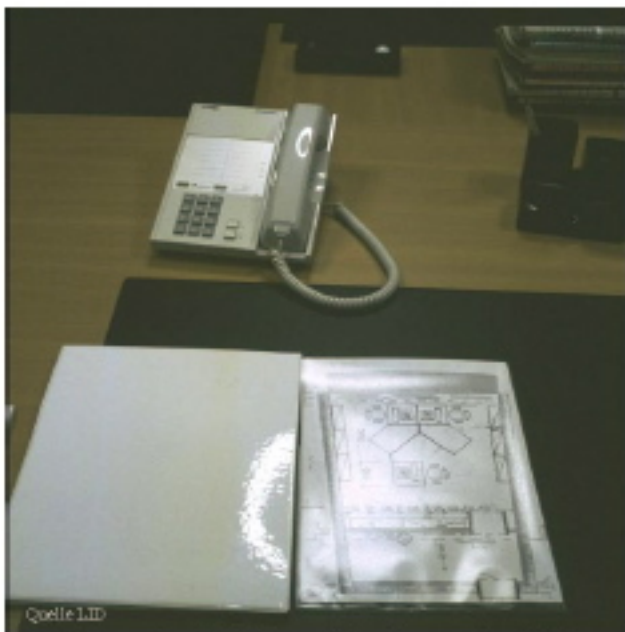
Abbildung 3: Schleierreflexionen der Allgemeinbeleuchtung auf dem Arbeitsdokument
